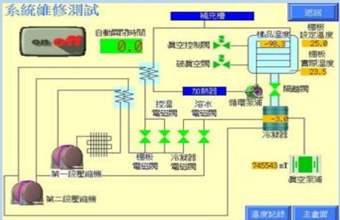
\* 冷凍乾燥機流程圖顯示系統操作過程各元件開關狀況，棚板設定及實際溫度、樣品平均溫度，冷凝器溫度，環境溫度及真空度設定值及值及實際值
